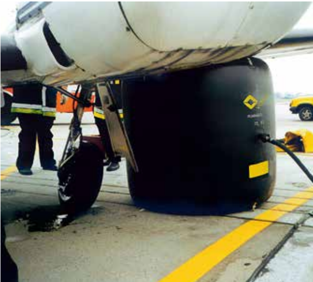
Nosta herkkiä rakenteita pehmeästi
